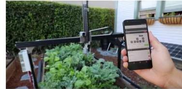
Le robot potager Farmbot est destiné à réintroduire la culture potagère dans nos modes de vie. Il s'agit d'un robot Open-Source conçu pour rendre un potager autonome. Les fonctionnalités techniques et le logiciel du robot permettent à l'utilisateur de programmer et de gérer son potager en optimisant l'espace et en réduisant l'apport en eau et en intrants. Farmbot apporte une autre dimension à l'agriculture
